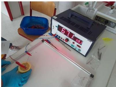
Um die Spannung zu messen, werden jeweils zwei Metalle in eine Zitrusfrucht gesteckt und mit dem Multimeter verbunden. Die Metalle werden nach jeder Messung ausgewechselt und verschiedene Kombinationen werden ausprobiert. Die Messungen werden bei verschiedenen Zitrusfrüchten wiederholt. Um die Diode zum Leuchten zu bringen, werden mehrere Metalle miteinander in Reihe geschaltet, um die Spannung auf ein Maximum zu erhöhen.
