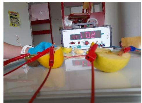
Magnesium und einer Zitrusfrucht in Reihe geschaltet werden. Dabei addierten sich beide Spannungen und die Energie, die zum Leuchten der Diode benötigt wurde, konnte erreicht werden.
